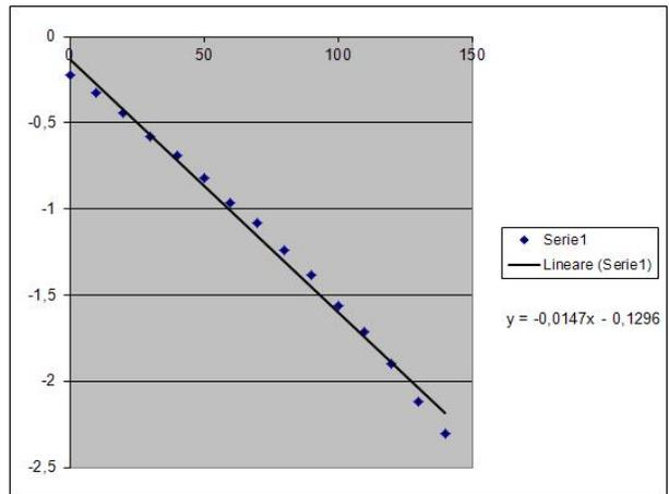
Figura 1: Piano semilogaritmico  $(t, \ln V)$  in cui è stata tracciata la retta che corrisponde all'andamento sperimentale dei punti. E' stata sovrapposta anche la retta di tendenza, il cui coefficiente angolare permette di dedurre il valore di  $C$
