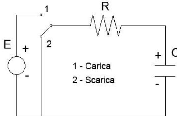
Un siffatto circuito ci dà la possibilità di esaminare separatamente i processi di carica e scarica e inserendo un voltmetro in parallelo, ai capi di  $R$ , determinare l'andamento della tensione  $V(t)$  in funzione del tempo  $t$ .
